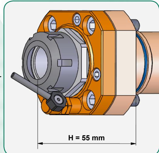
アンギュラ方式ツールのH寸法は装着面からコレットセンター線までの距離です。
