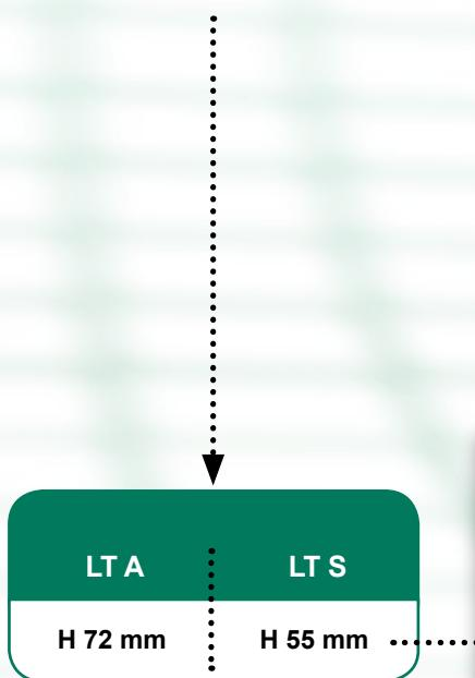
ストレート方式ツールのH寸法は装着面からコレット端面までの距離です。
